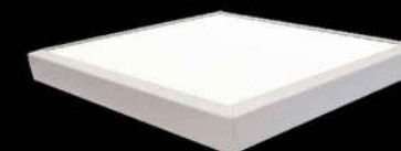
ОФИС-600X600-44 R с равномерной засветкой и опаловым рассеивателем Габариты 595x595x60 Световой поток — 6000 Лм Потребляемая мощность — 44 Вт
