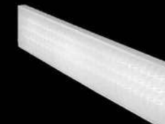
ОФИС-1200X300-66 Габариты 1195x295x40 Световой поток — 8400 Лм Потребляемая мощность — 66 Вт
